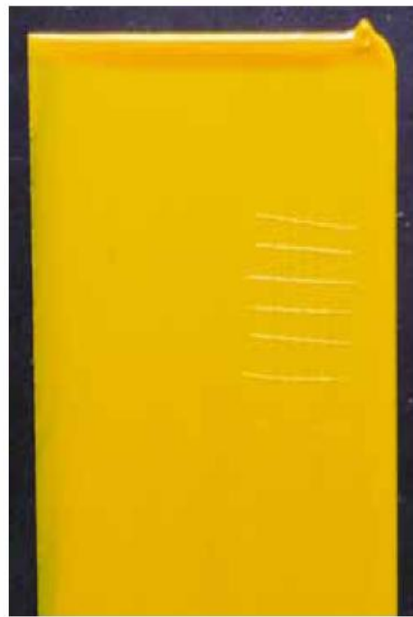
Табло, почистено с VpCI-429 и след това покрито с VpCI-386 Жълт
