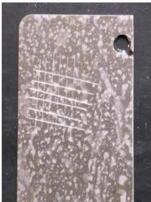
Табло, почистено с VpCI-429 и след това покрито с VpCI-386 Прозрачен
